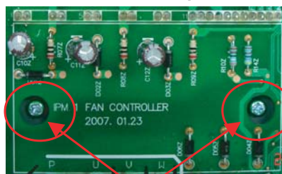
Fan IPM assemble position
